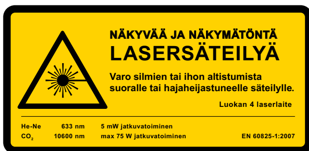
Kuva 11. Esimerkki yhdistelmämerkistä, jossa on lasersäteilyn varoitusmerkki ja turvallisuusluokan mukainen varoitusteksti.
