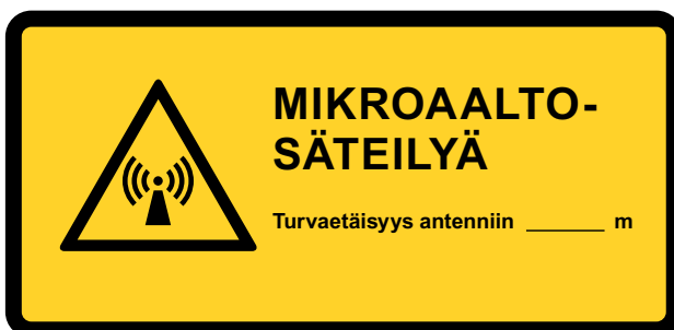
Kuva 8. Esimerkki yhdistelmämerkistä, jossa on ionisoimattoman säteilyn varoitusmerkki ja selittävä teksti.
