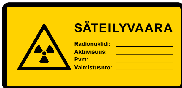
Kuva 4. Esimerkki säteilylähteen suojukseen kiinnitettävästä yhdistelmämerkistä.
