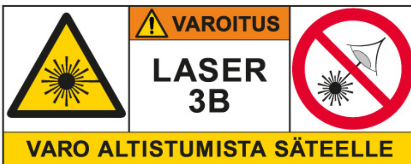
b) Esimerkkejä vaihtoehtoisista yhdistelmämerkeistä, joissa on lasersäteilyn varoitusmerkki ja turvallisuusluokan 3B mukainen varoitusteksti.
