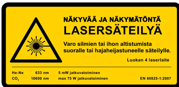
**Figure 11.** Example of a combination sign containing a warning sign for laser radiation and a warning text in accordance with the safety class. (Näkyvää ja näkymätöntä LASERSÄTEILYÄ = Visible and invisible LASER RADIATION, Varo silmien tai ihon altistumista suoralle tai hajaheijastuneelle säteilylle = Avoid exposure of the eyes or the skin to direct or scattered radiation, Luokan 4 laserlaite = Class 4 laser device, jatkuvatoiminen = continuously working)
